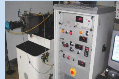
Tribometr adaptovaný na tribologii pístů za vysokých teplot
