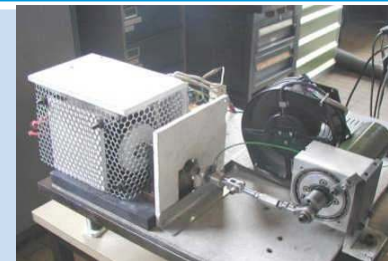
Tribometr adaptovaný na tribologii pístů za vysokých teplot
